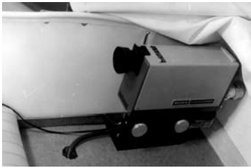
View of the TV camera installed in the basket of the baby carriage. Pohled na umístění TV kamery v košatém kočárku.
